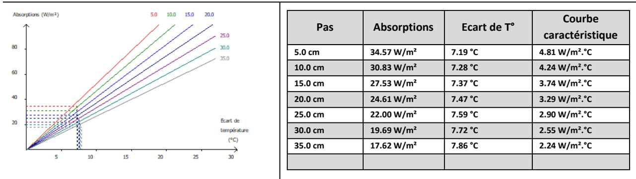
**Calcul selon EN 1264-2 et revêtement de sol type carrelage résistance thermique 0.02 m².K/W**
