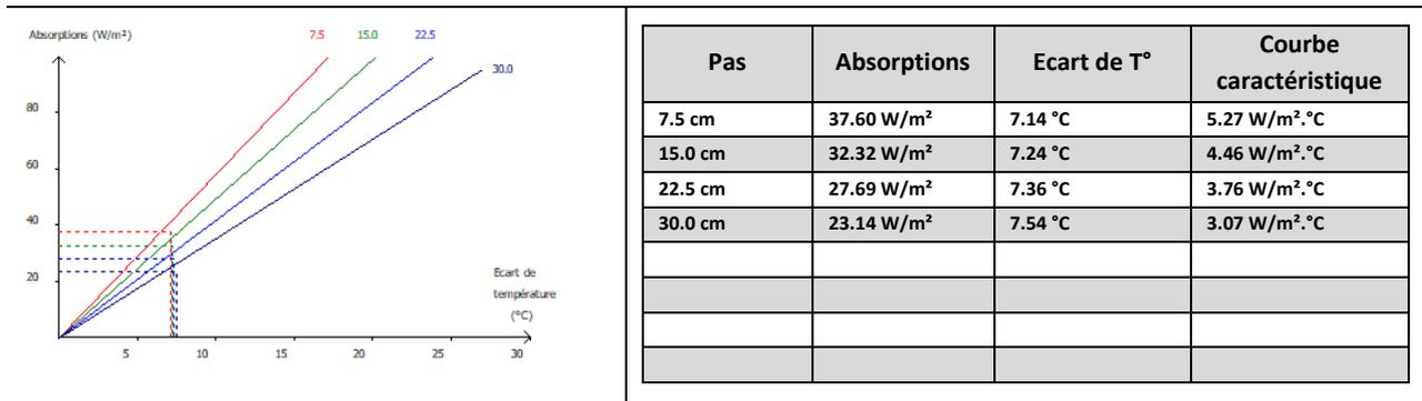
Calcul selon EN 1264-2 et revêtement de sol type carrelage résistance thermique 0.02 m<sup>2</sup>.K/W
